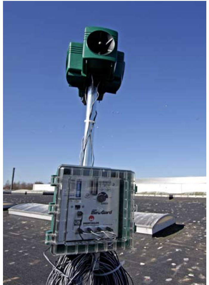
Det akustiske fugleskræmsel BirdGuard opsat på fladt tag for at holde stormmåger væk
