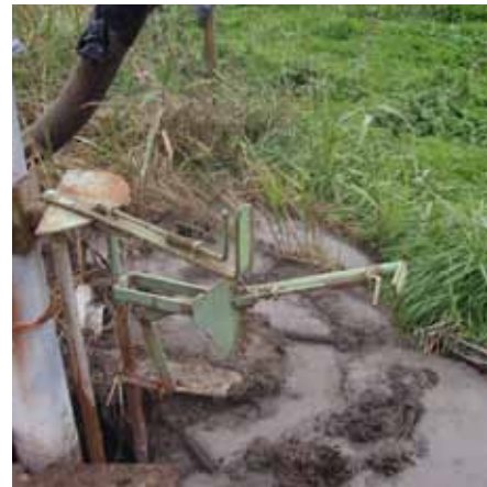
Udslip af gylle fra pumpe-system ved gyllebeholder.
